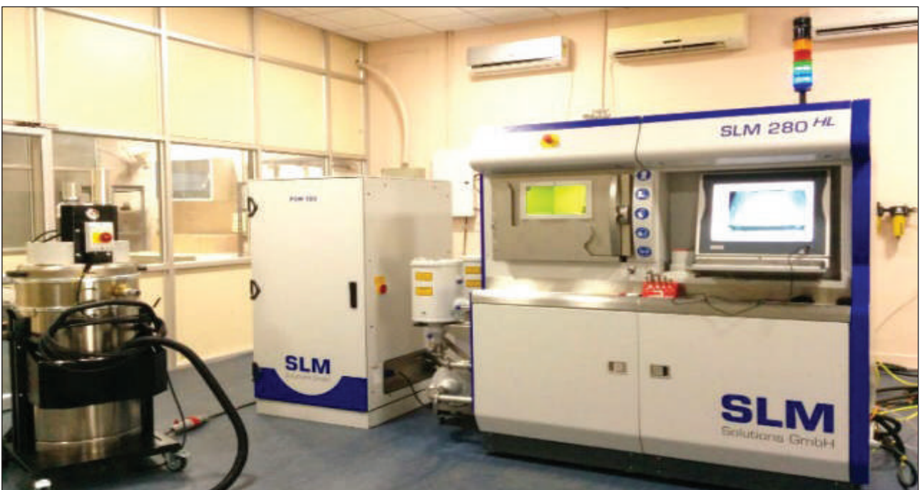
चित्र 1: एआरसीआई में धातु चूर्ण संस्तर-योजक विनिर्माण प्रणाली
