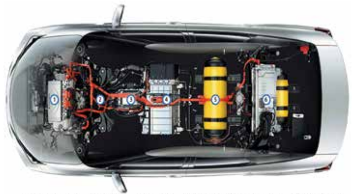
1. शक्ति नियंत्रक ईकाई, 2. मोटर, 3. वृद्धि परिवर्तक, 4. ईंधन सेल, 5. हाइड्रोजन टंकी, 6. बैटरी
