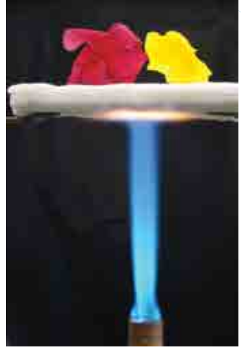
चित्र 1: सिलिका एरोजेल, दुनिया का उत्कृष्ट थर्मल इन्सुलेटर
