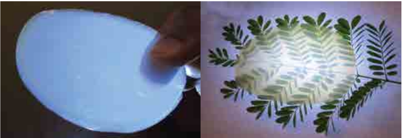
चित्र 3: (ए) अंधेरे में सिलिका एरोजेल का नीला रंग, (बी) पारदर्शी सिलिका एरोजेल का पीले रंग जब चमक के बिना देखा जाए
