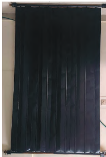
\text{CuMnNiO}_4 स्पिनल नैनोकण आधारित अवशोषक लेपित फ्लैट प्लेट पैनल
