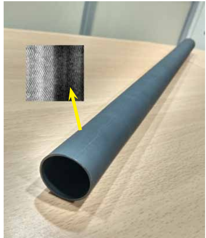
चित्र 2: परमाणु अनुप्रयोगों के लिए सिंटरित SiC - 2.5% सीएनएफ समग्र पतली ट्यूब
