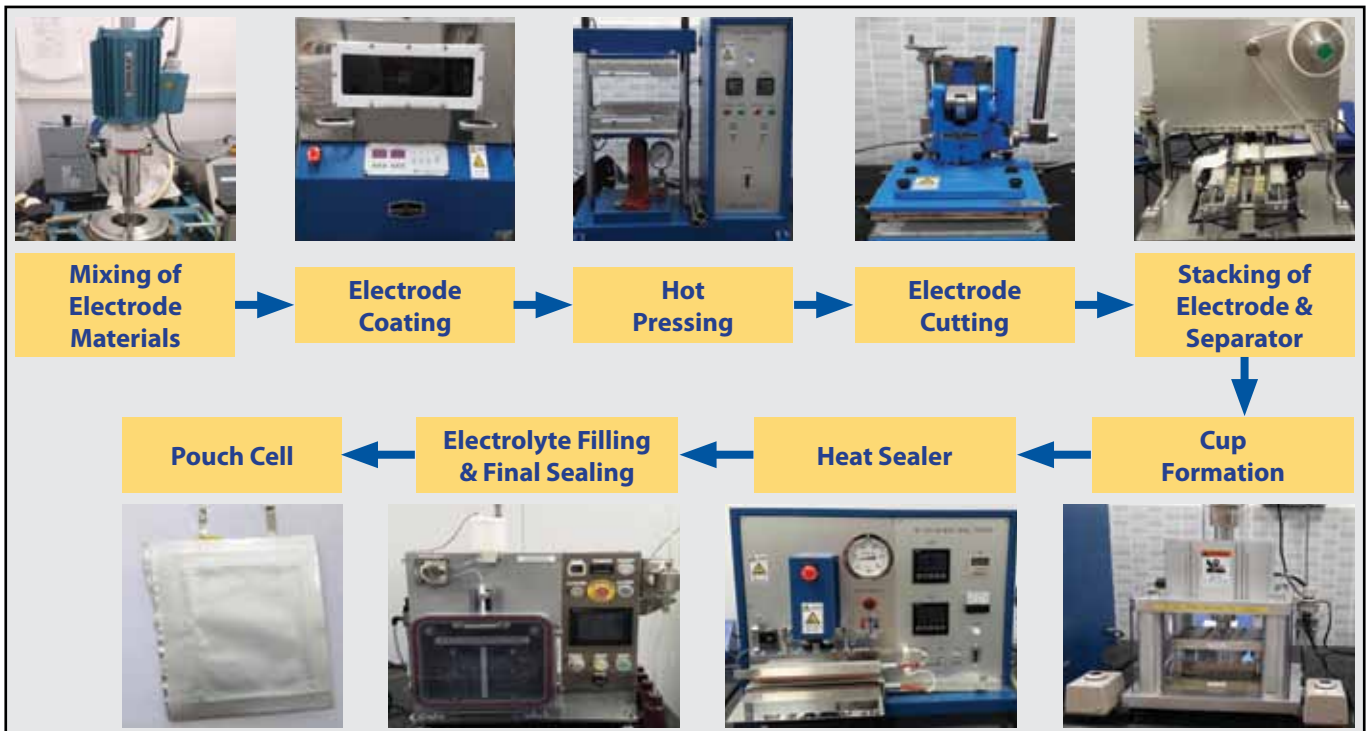
चित्र.1 पाउच सैल निर्माण लाइन
