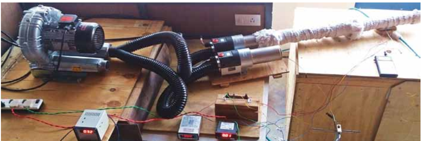
चित्र 3: टीईजी निष्पादन मूल्यांकन के लिए प्रयोगशाला स्तर परीक्षण रिग
