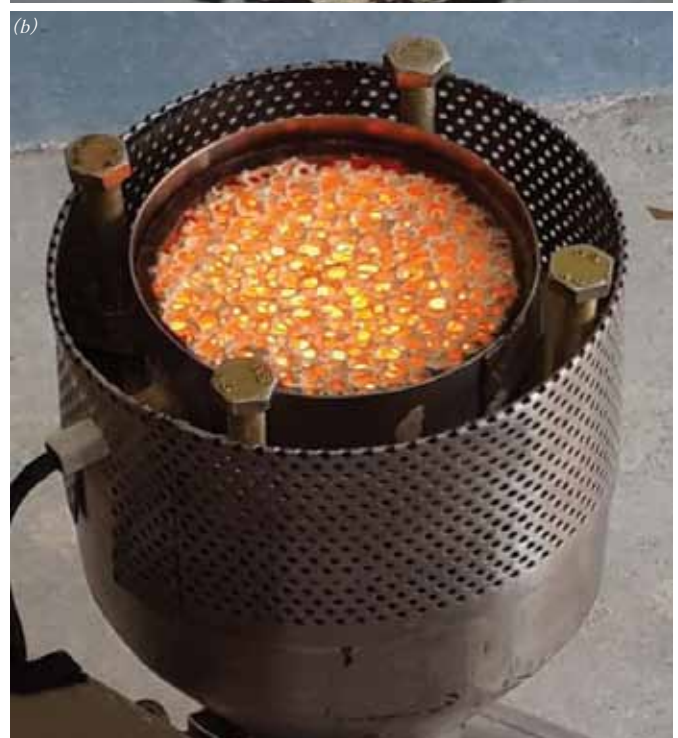
चित्र 1: (क) कॉर्डिएराइट आधारित फोम (ख) फोम के भीतर लपटों का स्थिरीकरण।
