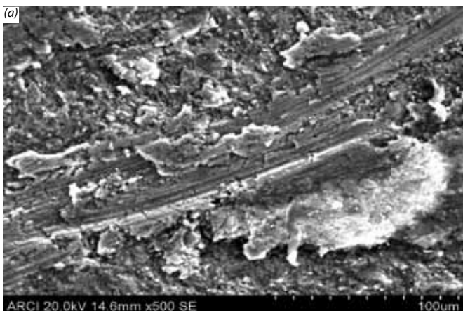
चित्र 2: घिसा हुआ सतह आकारिकी (ए) बर्रे Al-Cu-मिश्रधातु और (बी) सूख पिन-ऑन-डिस्क फिसलन घिसाई परीक्षण के बाद एमएओ लेपित Al-Cu-CNT संमिश्र।
