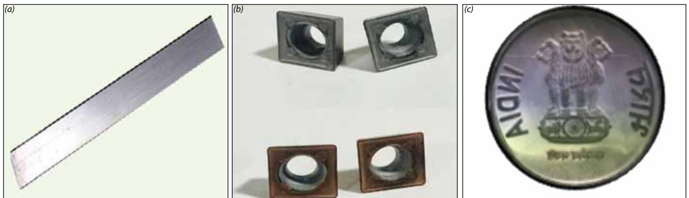
चित्र 2: ए) पॉलिमर काट WC ब्लेड, बी) नैनोसमग्र + कार्बो-नाइट्राइड लेपित मिलिंग आवेषण, सी) TiCrN + कार्बो-नाइट्राइड लेपित को पिघलाने वाला डाइ।
