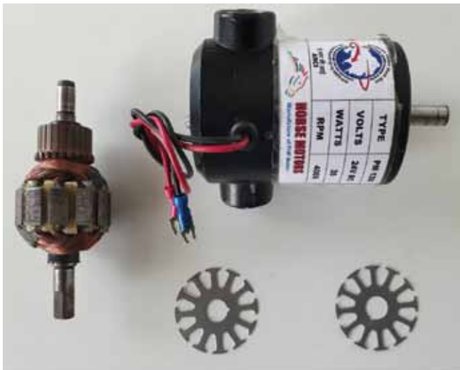
चित्र 1. रोटर और स्तरिका के साथ विकसित प्रोटोटाइप मोटर
