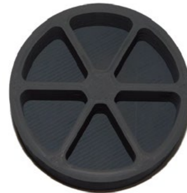
Fig. 1 FDM 3D printed light-weight SiC prototype Size: 75 mm (D) × 15 mm (H)
