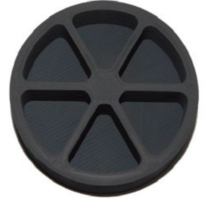
चित्र 1. एफडीएम 3डी प्रिंटेड हल्के SiC प्रोटोटाइप, आकार: 75 मिमी (व्यास) स 15 मिमी (ऊंचाई)
