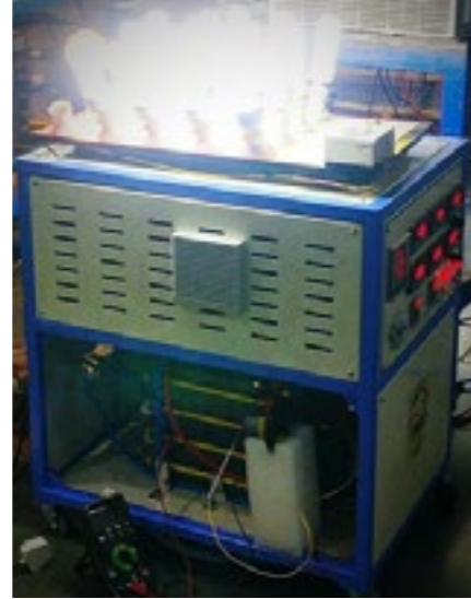
चित्र 1 : पीईएमएफसी प्रणाली के आभासी प्रदर्शन के दौरान का फोटोग्राफ, जो एसी लाइटिंग को बिजली देने के लिए बिजली स्थिति को एकीकृत करती है
