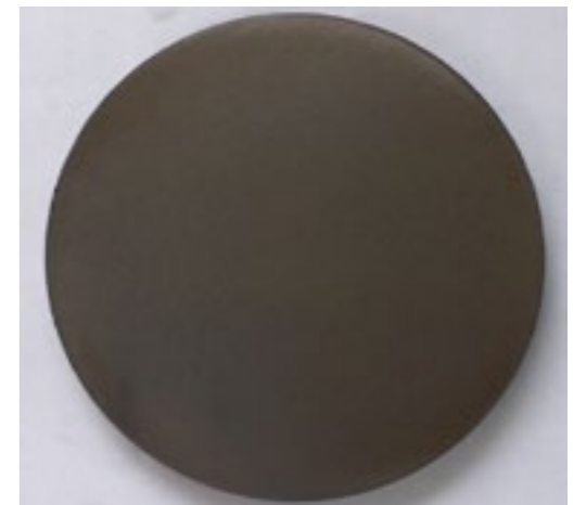
चित्र 4. 100 मिमी व्यास की उच्च प्रबलता, उच्च-घन वाले टंगस्टन आधारित प्लेटें
