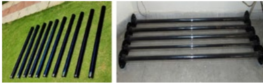
चित्र 5: एसएस 304 सबस्ट्रेट पर स्पिनल नैनोमिथ्र आधारित अवशोषक विलेपन की स्पेक्ट्रल चयनात्मकता और क्षेत्र सत्यापन के लिए विकसित 1 मीटर ट्यूब और 2 मीटर प्रोटोटाइप वाले संयोजित रिसीवर की कई संख्याओं का प्रतिबिंब
