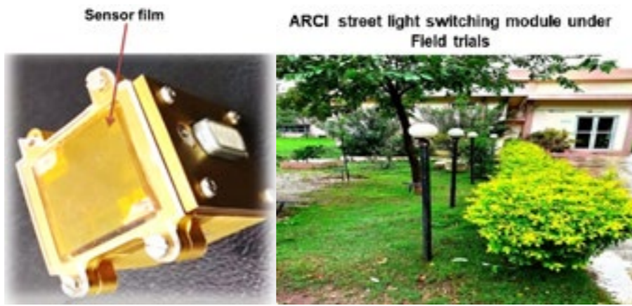
चित्र 5 "सर्किट एकीकृत फोटो-सेंसर" का डिवाइस फोटोग्राफ पूरी तरह से एआरसीआई में बनाया गया है; एआरसीआई में एआरसीआई निर्मित सौर प्रकाश स्विचिंग सेंसर के लिए क्षेत्र परीक्षण किया गया।
