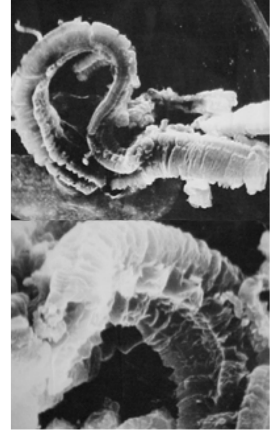
चित्र 1. कृमि संरचना को प्रदर्शित करने वाले अपशक्तित ग्रेफाइट का एसईएम माइक्रोग्राफ
