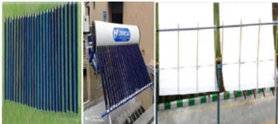
चित्र 2: सौर वॉटर हीटर और औद्योगिक प्रक्रम ताप अनुप्रयोगों और प्रोटोटाइप सौर वॉटर हीटर और परवलयिक ट्रफ आधारित सीएसटी प्रणाली दोनों के सत्यापन के लिए उद्योगों को विकसित और आपूर्ति किए गए प्रोटोटाइप सौर अवशोषक ट्यूबों की कई संख्याओं की प्रतिबिंब
