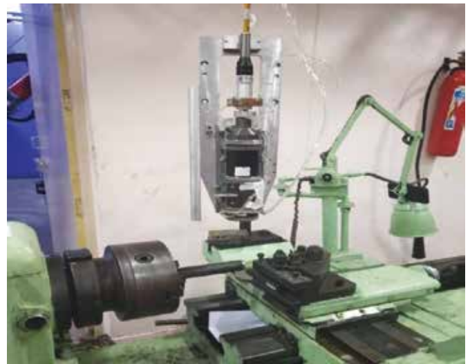
चित्र 2: एआरसीआई में लेजर- सहयोगी मशीनिंग की स्थापना
