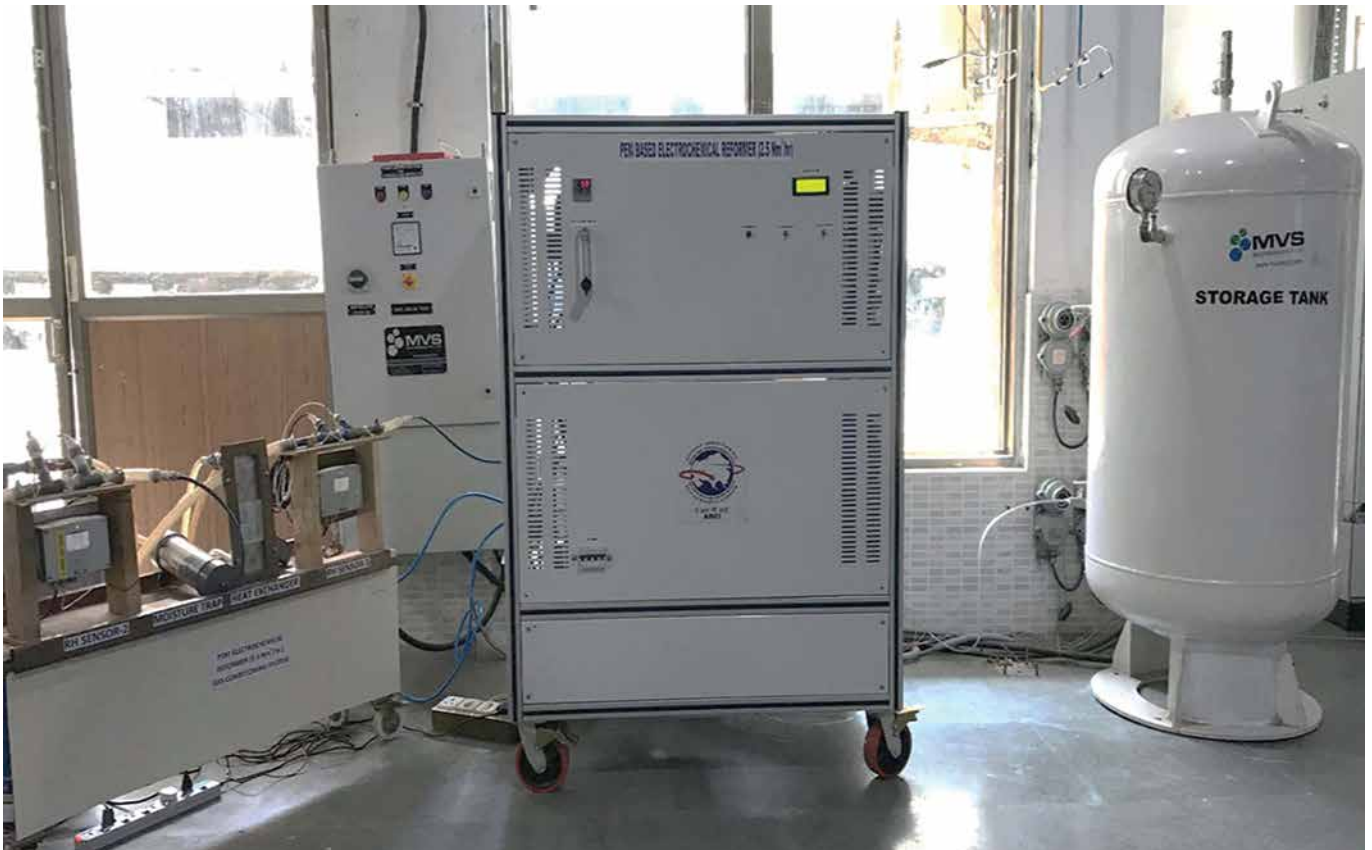
चित्र 1: भंडारण टैंक के साथ 2.5 Nm 3 /घंटा हाइड्रोजन उत्पादन क्षमता वाले एकीकृत ईसीएमआर इकाई
