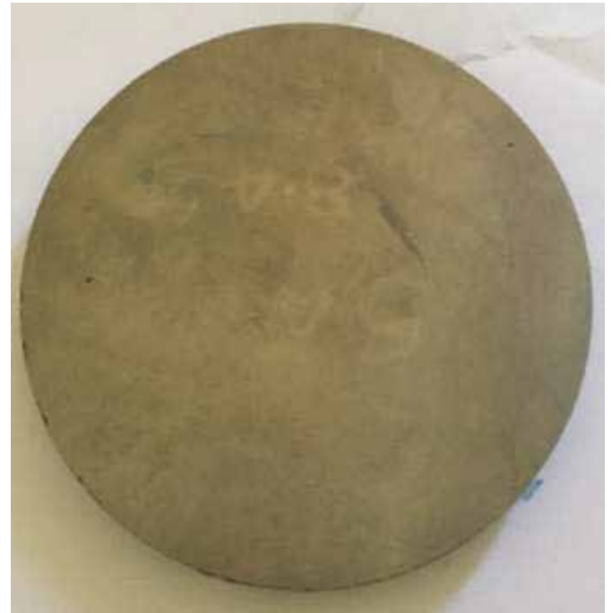
चित्र 2. एसपीएस द्वारा निर्मित 95 मिमी व्यास वाले उच्च सामर्थ्य, उच्च-प्रतिपादव डब्ल्यू-टैक शीट
