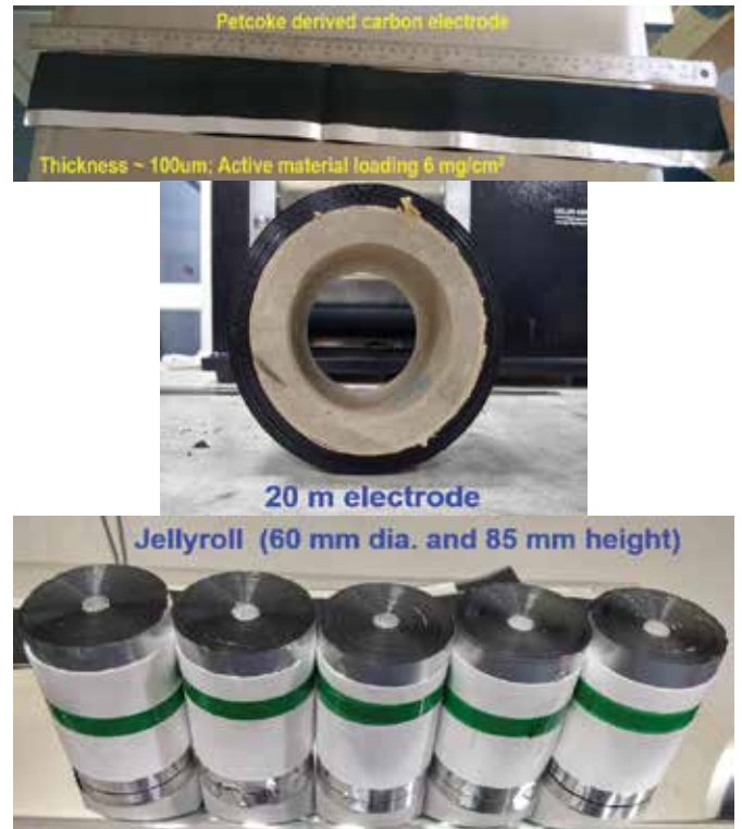
चित्र 2: पेटकोक व्युत्पन्न सक्रिय कार्बन इलेक्ट्रोड और जेली रोल को प्रायोगिक स्तर सुपरकैपेसिटर सुविधा पर तैयार किया गया।
