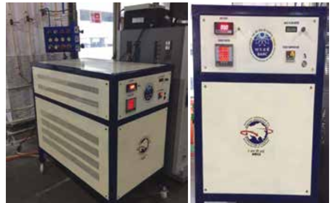
चित्र 1: बीएआरसी में स्थापित संयंत्र के अपने संतुलन के साथ पीईएमएफसी प्रणाली
